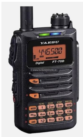
Fot. 1.2. Przykład radiostacji z klawiaturą DTMF – FT-70DE. Pracuje emisjami FM i C4FM
